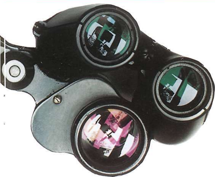
Zgornji daljnogled ima večplastne (MC) prevleke, spodnji pa en sam protiodsejni sloj. Vidna je razlika v številu in intenziteti odsefov
