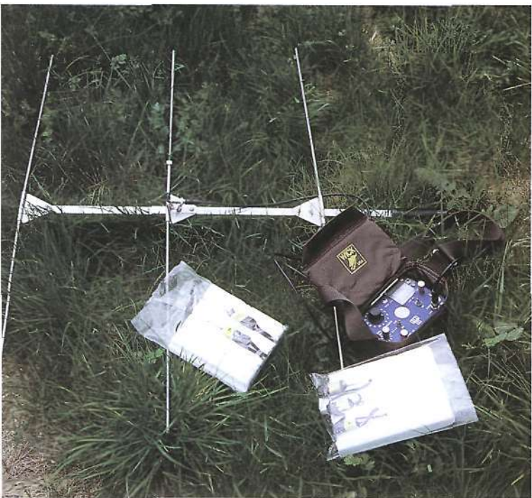
Foto: D. Vojnitič Oprema za radijsko telemetrijo: oddajniki (teža 10 g), sprejemnik in usmerjena antena tipa Yaggi. V povezavi s sprejemnikom se običajno uporabljajo tudi slušalke (niso na sliki), ki zmanjšujejo vplive nezaželenih шумov iz narave.
