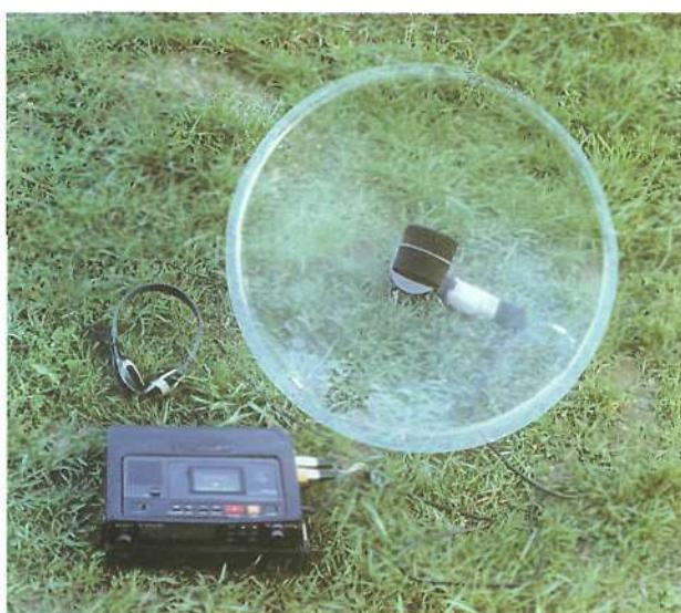
slika 1: Parabolni mikrofon Telinga Pro 5 S in digitalni kasetofon Sony TCD-D10 Pro II - oprema, ki jo avtor prispevka uporablja za snemanje ptičjih zvokov.
