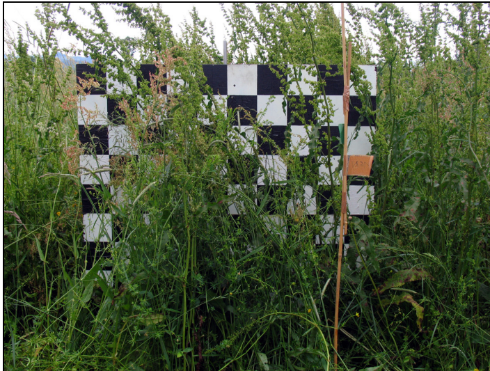
Slika 3: Tabla z vzorcem šahovnice za ocenjevanje efektivne višine vegetacije
