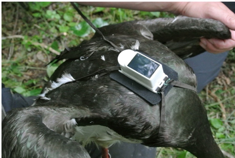
Slika 18: GPS/GSM sledilna naprava je nameščena na hrbtu ptice s teflonskimi naramnicami po principu nahrbtnika.
