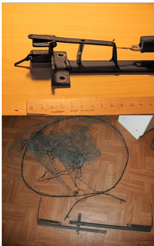
Slika 11: Sprožilni mehanizem pasti in past (levo; foto: Urmas Sellis) in past nameščena v naravi (desno; foto: Sarah Robič)
