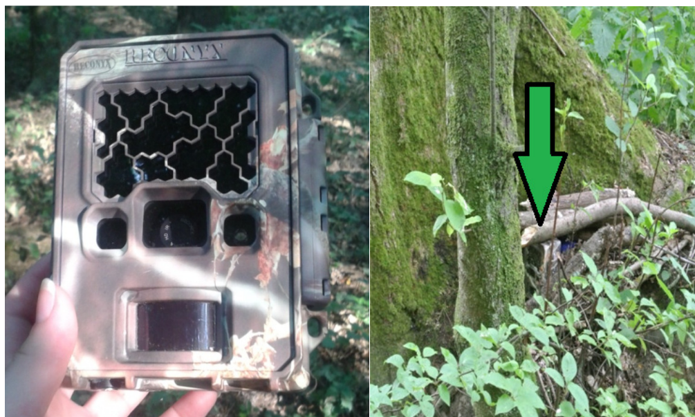
Slika 9: Avtomatska kamera Reconyx in primer namestitve v naravi (foto: Sarah Robič)
