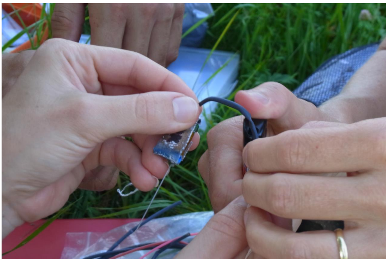
Slika 2: Upogibanje termo požirke v obliko naramnice (foto: Primož Kmecl)
